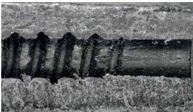
Schnittbild: Tubuswand nach dem Verschrauben
